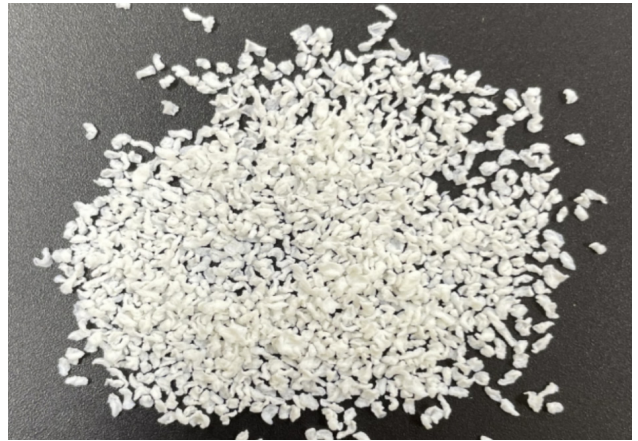
(图为利用木浆制造的高吸水、环保型材料粒子)
