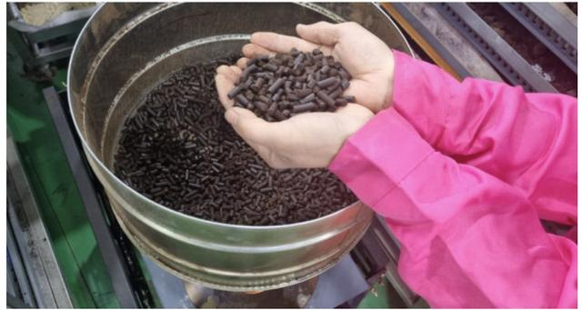
ENF能源代表南顺德(音)在庆尚北道高灵市运营着一家利用咖啡渣生产固体燃料颗粒的工厂。因回收到的咖啡残渣大部分水分含量较高，该企业将回收的咖啡渣进行了为期7天左右的干燥后，经过调配制成新型燃料。
