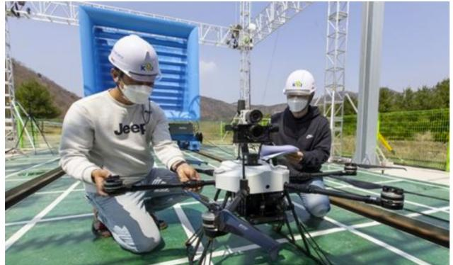
移动型地面控制站通过与无人机的数据传输，向无人机传达检查方案，并用无人机拍摄的视频分析设施的安全状态。损坏检测软件基于无人机拍摄的图像用 AI 应用算法提高测量的精确度，并对铁路设施各个部分的检测影像进行分类，用二维和三维显示损坏位置，便于检查者掌握损坏情况。
